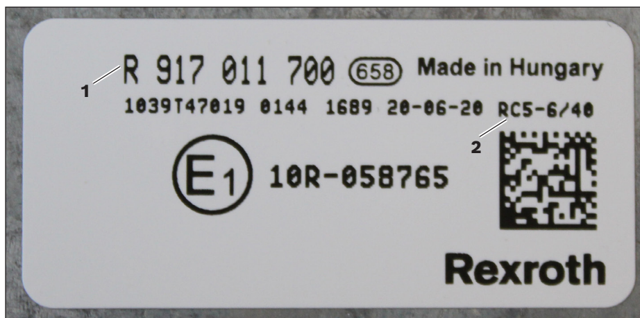
Rys. 2: Tabliczka znamionowa RC5-6/40
