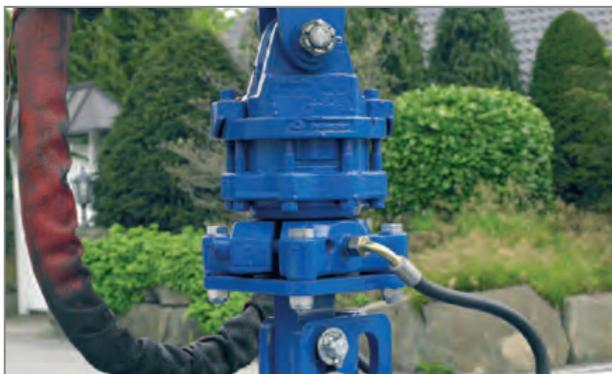
Endlos-Drehservo mit Drehservokippeinheit
