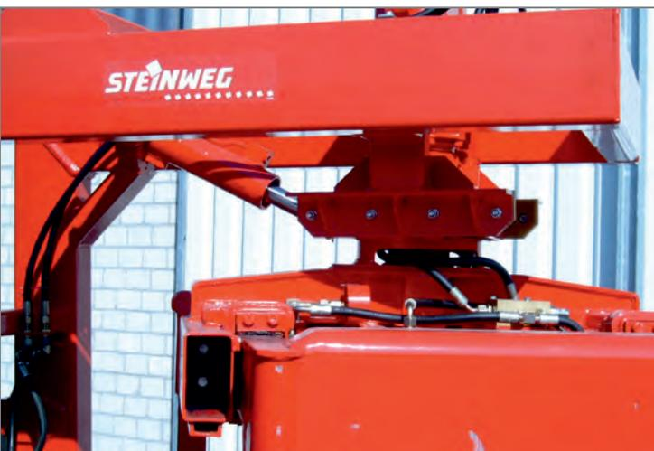
Stapler-Tragarm mit Endlos-Dreh servo und Stabilisator
