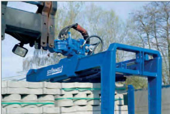
Endlos-Drehservo mit Drehservokippeinheit
