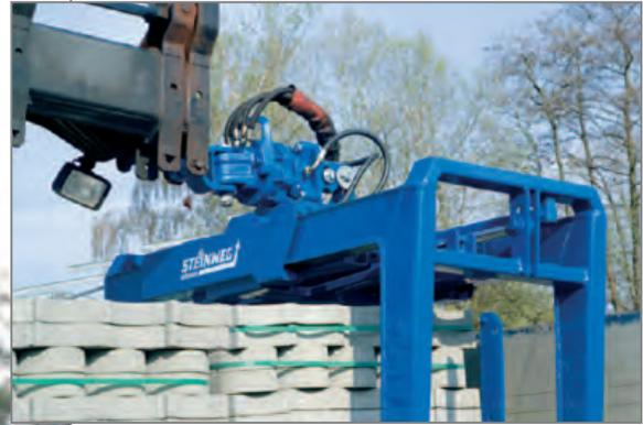
Endlos-Drehservo mit Drehservokippeinheit
