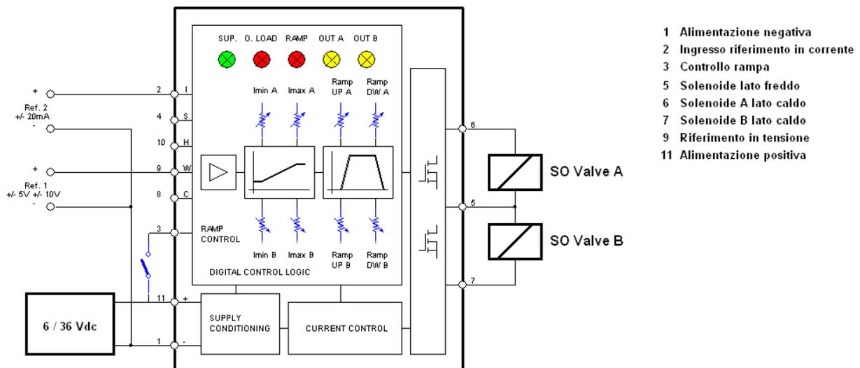
Collegare la scheda secondo lo schema di collegamento, senza alimentarla. Ruotare in senso antiorario i trimmer di regolazione per almeno 10 giri, e posizionare sullo 0 centrale il potenziometro esterno o il segnale di riferimento. Alimentare la scheda, verificare l'accensione del led verde e l'assenza di pilotaggio (led giallo spento). In caso contrario verificare i collegamenti e l'effettiva rotazione a 0 dei trimmer e del potenziometro esterno.
