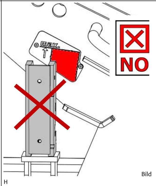
Zum Transportieren des Gerätes **ohne** Greifgut erfolgt in der Leerhub Position“ (siehe Bild I).
