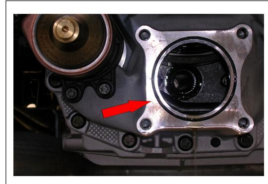
2) Inserire l'albero di corredo nel cambio. Controllare l'integrità delle guarnizioni OR incorporato nel piano posteriore del portello del cambio. Nel caso sia deteriorato, sostituirla con la guarnizione compresa nel nostro kit albero.
